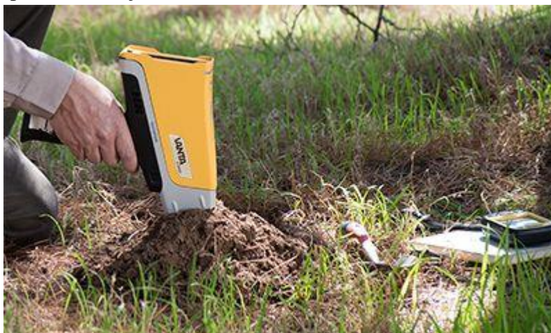
Figura 13. Exemplo da utilização de um analisador elementar com XRF em campo.
